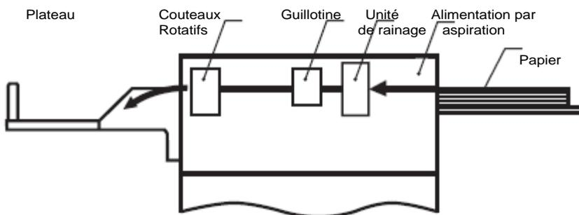
Principe de la fonction de rainage et coupage transversal
